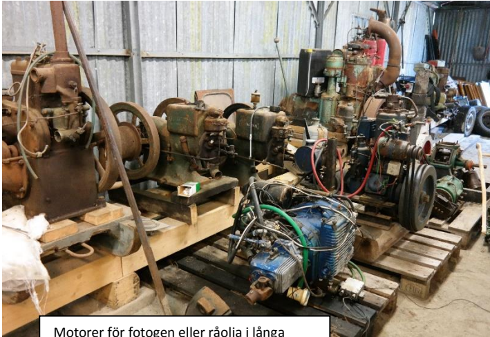
Motorer för fotogen eller råolja i långa rader. De har använts för att driva tröskverk, för vedkapning eller i båtar.
